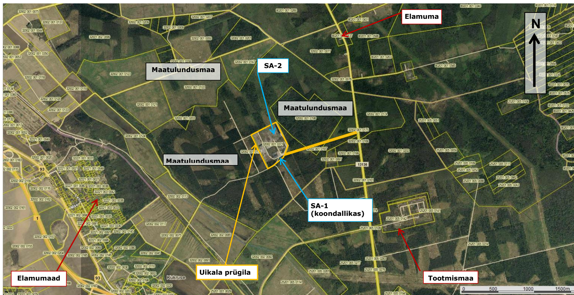
Kaart 1 Uikala prügila asendiplaan (Maa-Ameti GIS portaal, M 1 : 19 647). Saasteallikateks on prügilagaasi konteinertüüpi koostootmisjaama sise põlemismootorite suitsugaaside väljajamisavad (tähistatud SA-1, koondallikas) ja tõrvikpõleti (tähistatud SA-2).
